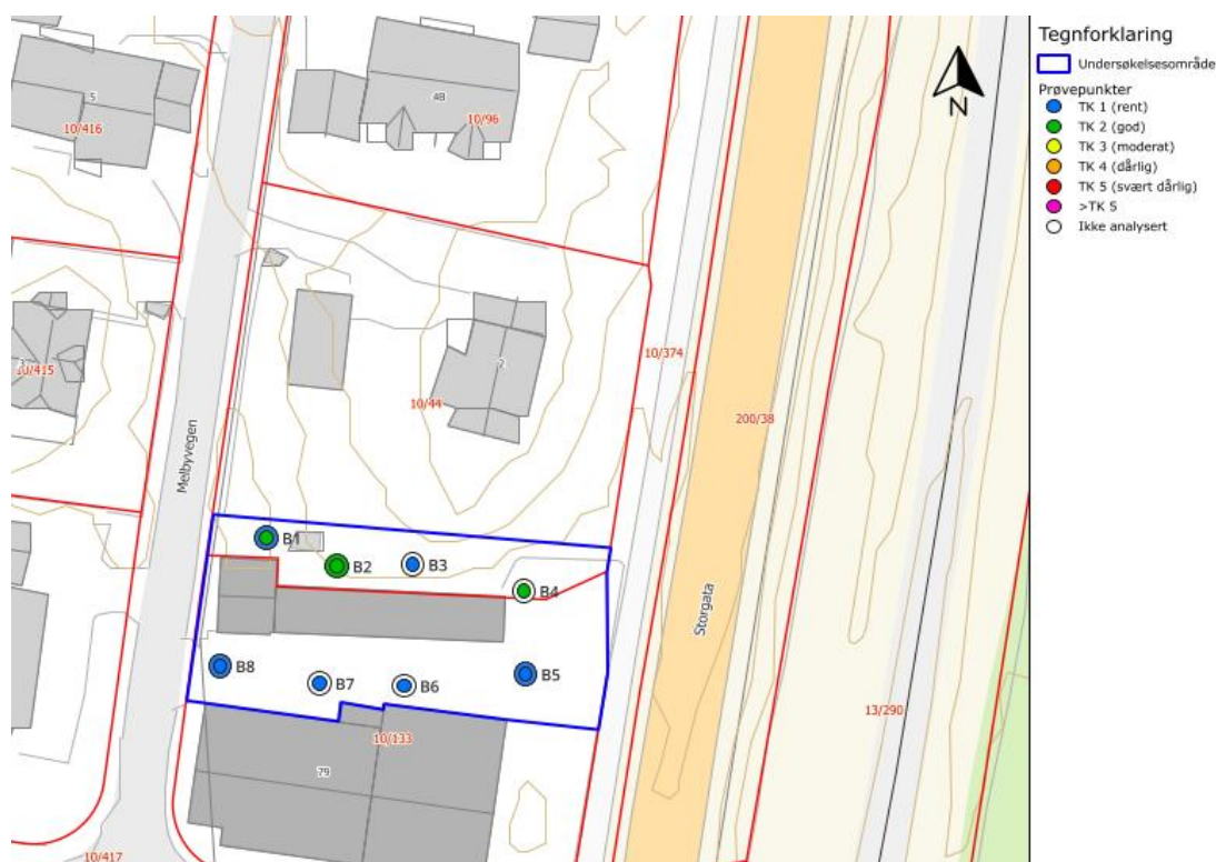
Figur 2: Oversikt over prøvepunktene i forbindelse med miljøprøvetakningen og kornfordelingsanalysene
