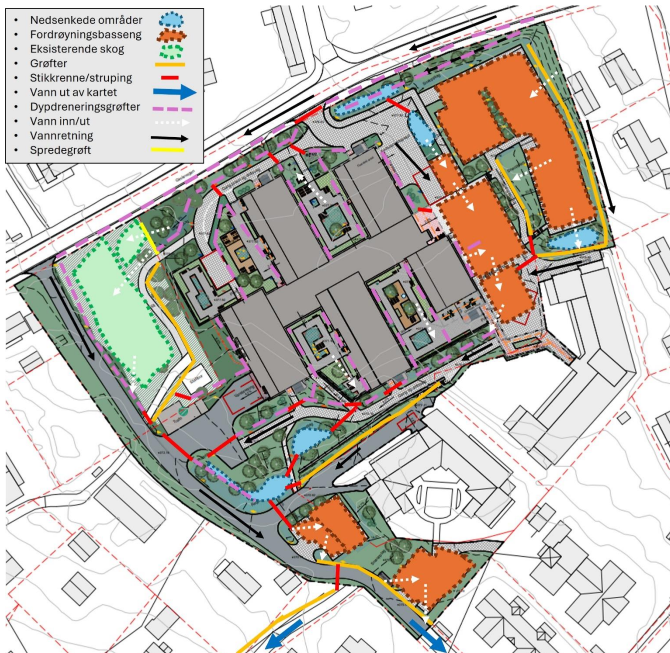
Figur 17 Grovt skissert plan for håndtering av overvann. Dypdreneringsgrøfter går ut fra taknedløp og vannet fordrøyes før det slippes videre.
