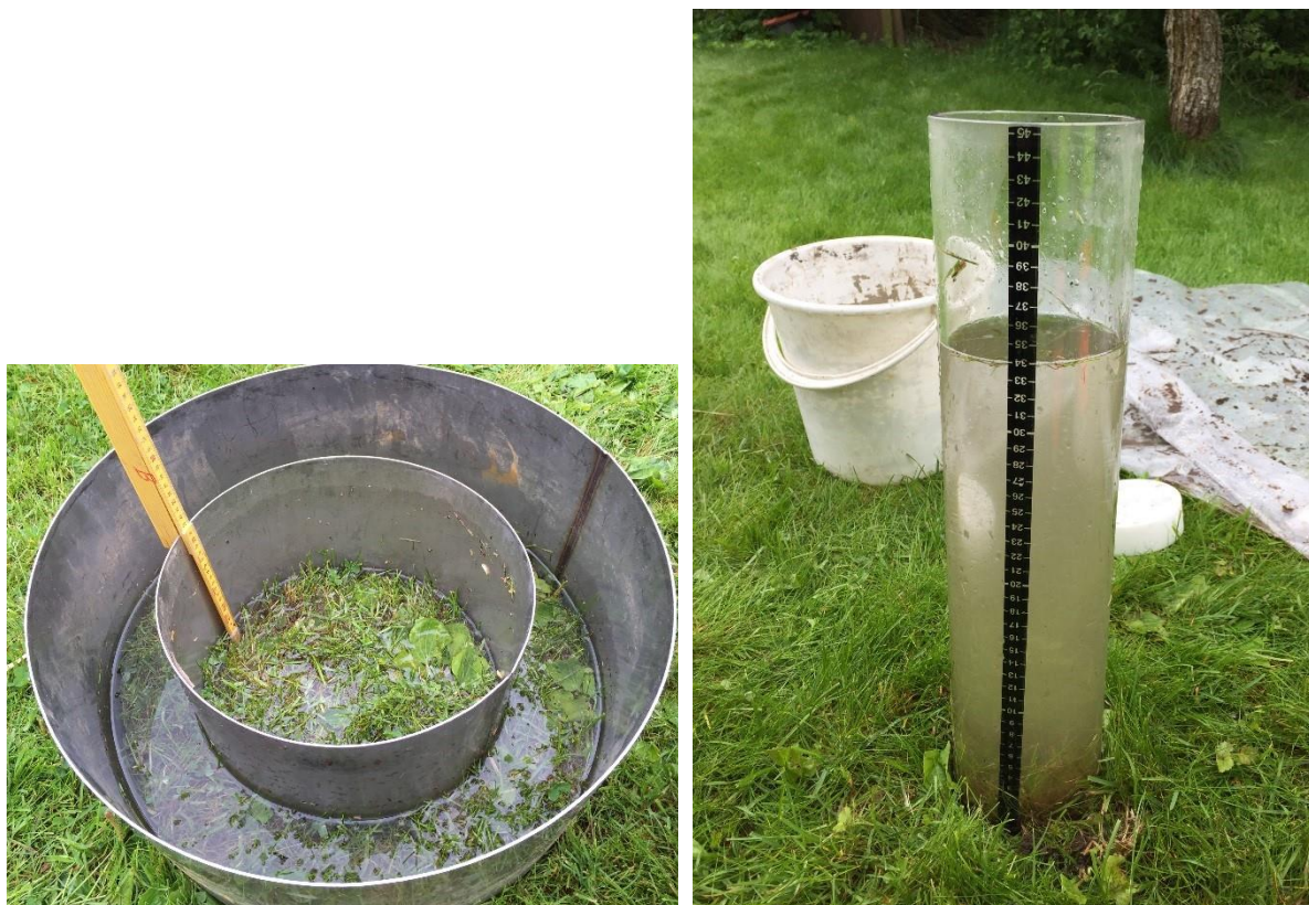
Figur 23. Bilder viser måling av infiltrasjonskapasitet ( K ) på en grasdekt overflate (overflateinfiltrasjon) med bruk av dobbeltring infiltrometer (venstre) og MPD-rør (høyre). (Foto: Bent Braskerud).
