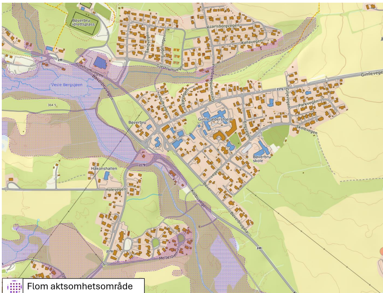
Figur 12 NVE sitt aktsomhetsområde for flom. Planområdet ligger utenfor aktsomhetsområdet. Kartet er hentet fra Scalgo.
