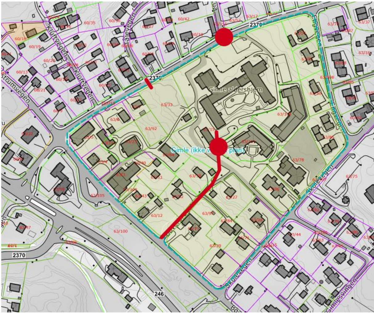
Figur 16 viser innstikk VA og slokkevannsutttak
