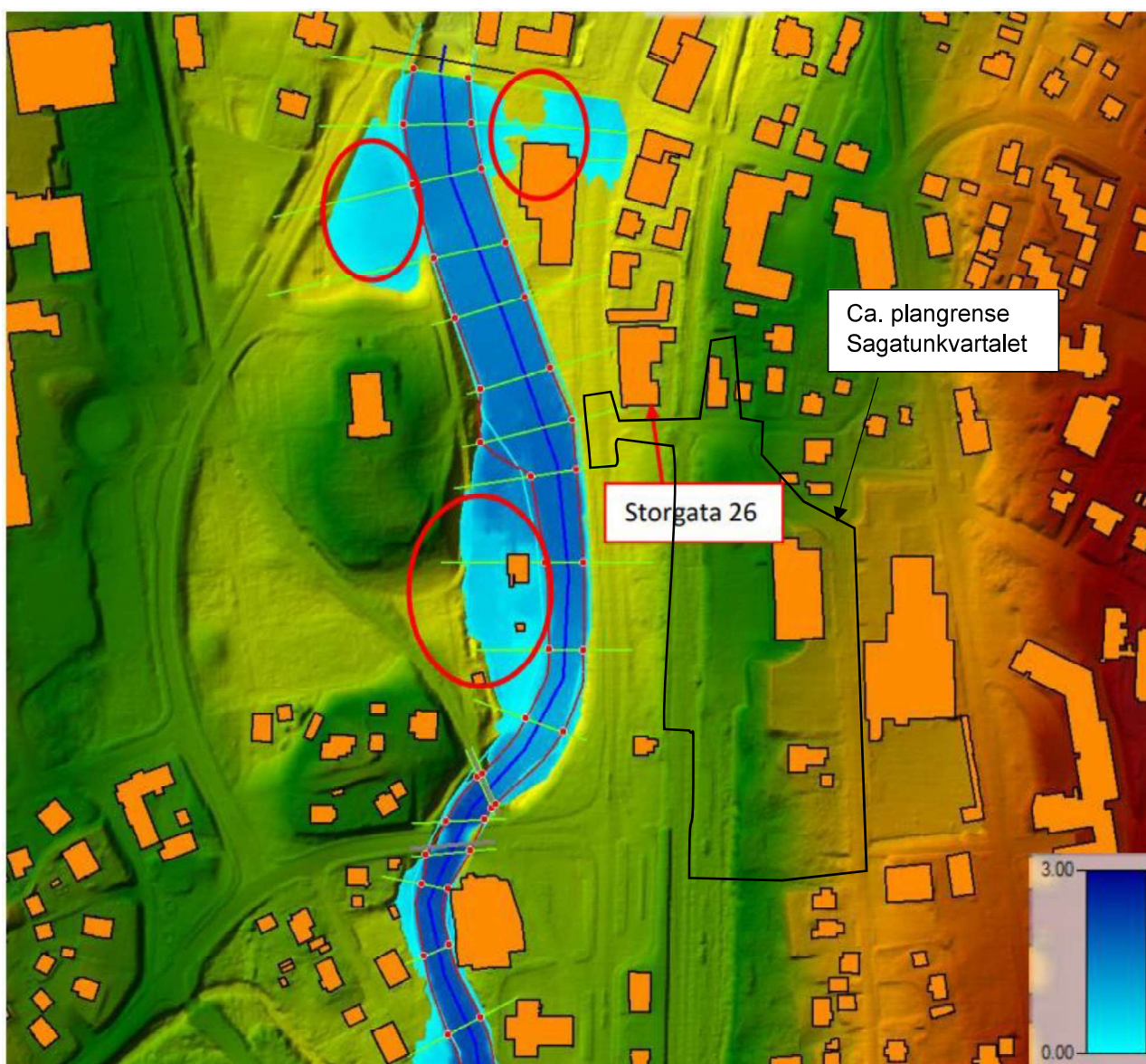
Figur 3-3 Kart over modellområdet som viser vanddybder [m] ved en 200-årsflom
