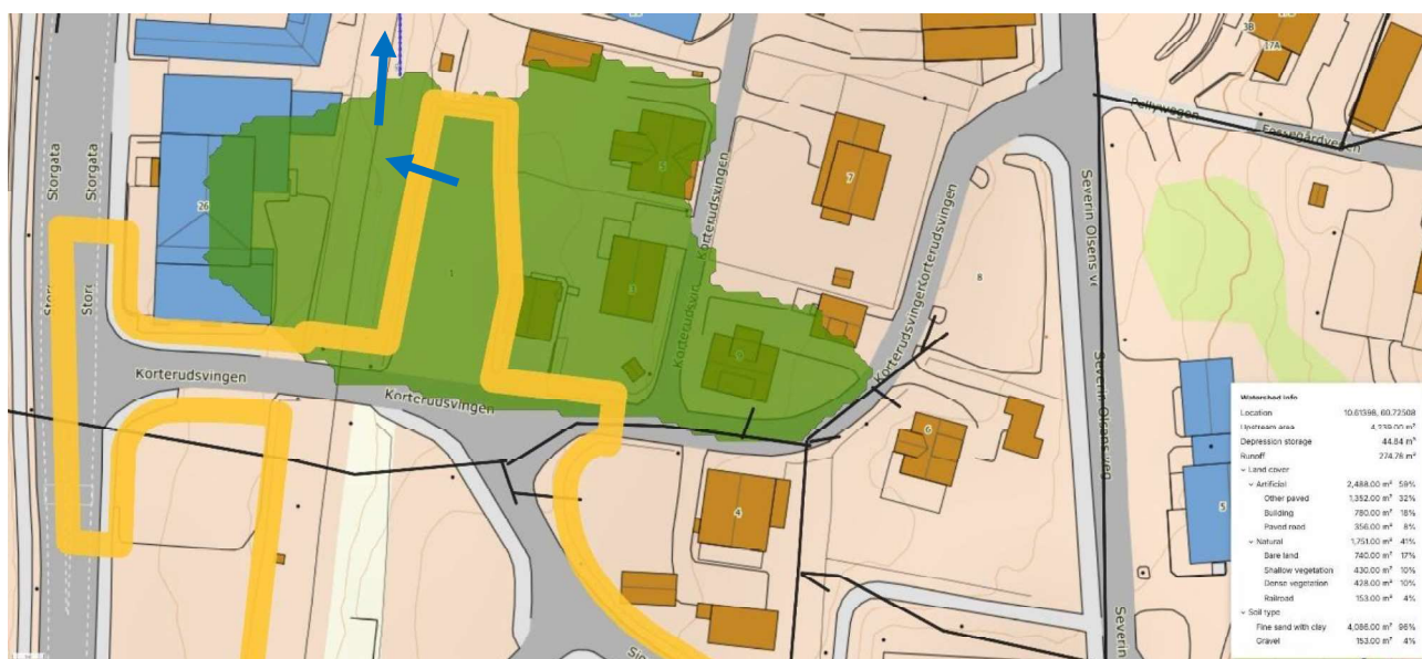
Figur 22 Nedbørfelt som drenerer parkeringsplassen i den nordlige delen av feltet. Plangrensen er markert. Nedbørfeltet er generert av Scalgo. Avrenningen skjer nordover langs jernbanen jf. blå pil.
