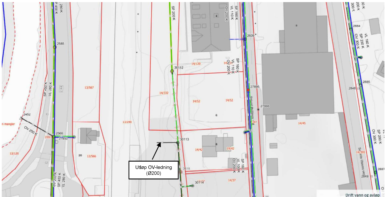
Figur 14 Kart over VA-ledninger omkring Sagatunet og i Sigurd Østliens veg. Dimensjon av overvannsledningene [mm] er markert, sammen med utløp av en OV-ledning i planområdet.
