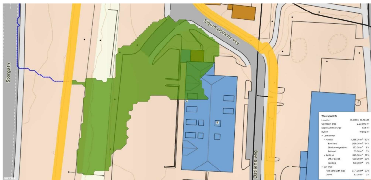
Figur 23 Nedbørfelt nord-vest for Sagatunet. Feltet er generert av Scalgo.
