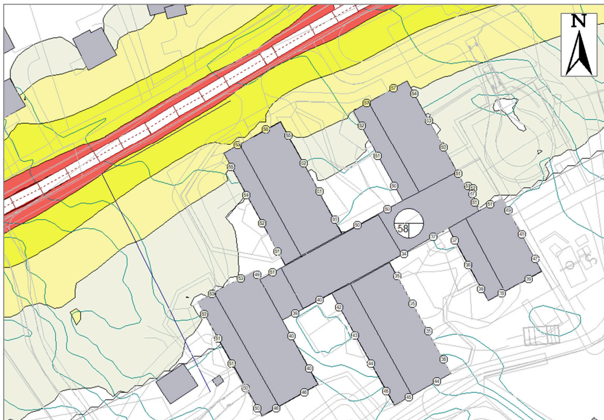
Figur 4-2: Utsnitt fra støysonekart, L_{DEN} 1,5 meter over terreng. Rød støysone > L_{DEN} 65 dB, Mørkegul støysone > L_{DEN} 60 dB, Gul støysone > L_{DEN} 55 dB, Grønn støysone > L_{DEN} 50 dB (kun relevant for uteoppholdsareal til sykehjem og ikke for boliger).
